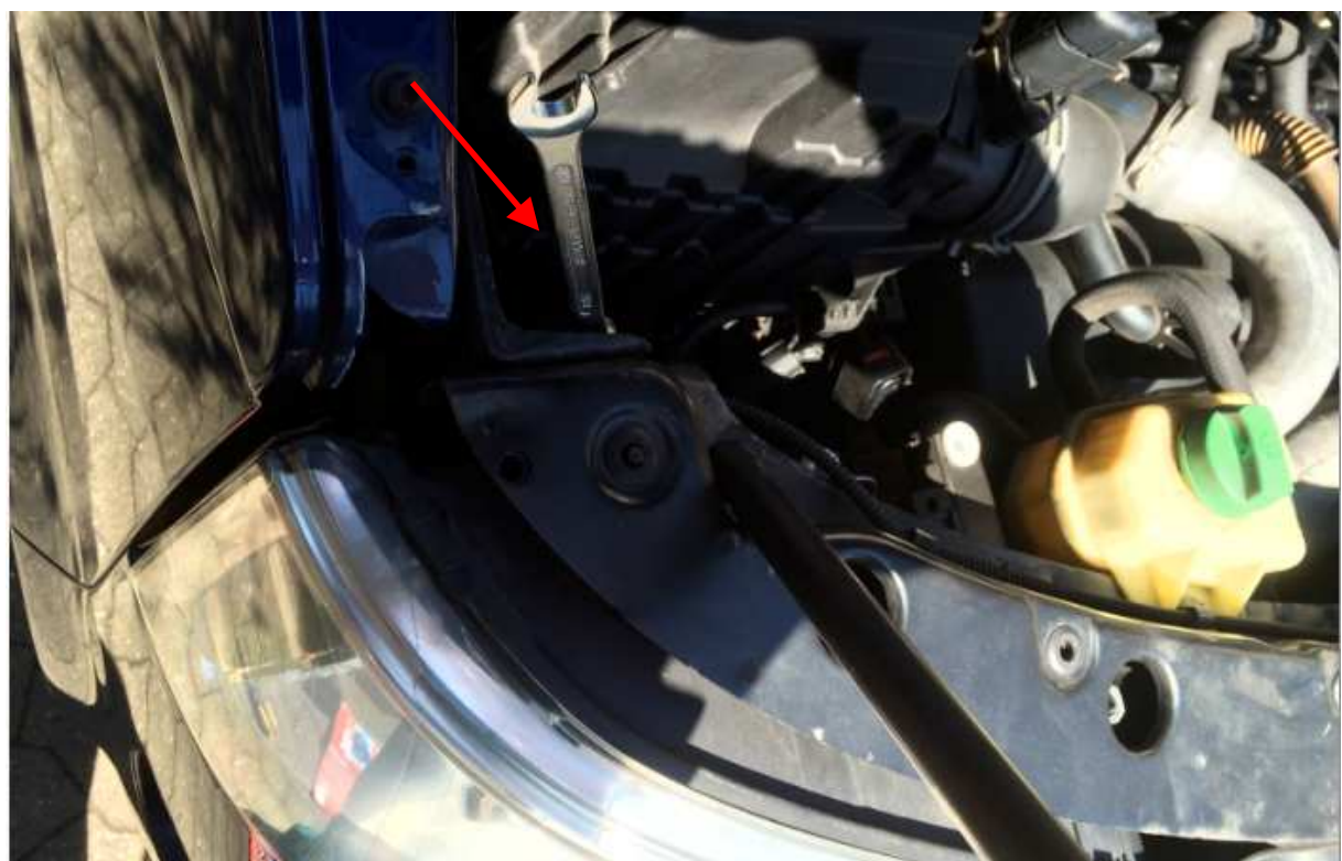
Wer will, kann den Schlosssträger lösen um mehr Platz zu bekommen.
