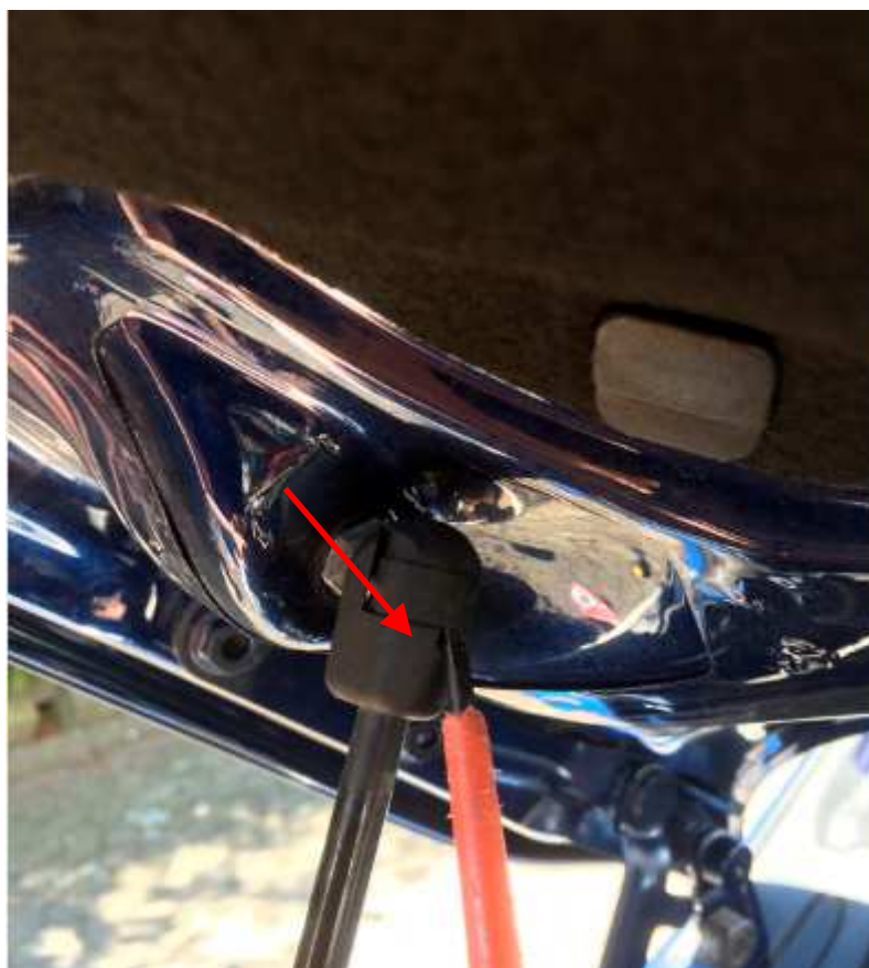
Wer will, kann die Gasfeder für mehr Platz lösen. Feder leicht anheben, dann Kugelgelenk herausziehen.
