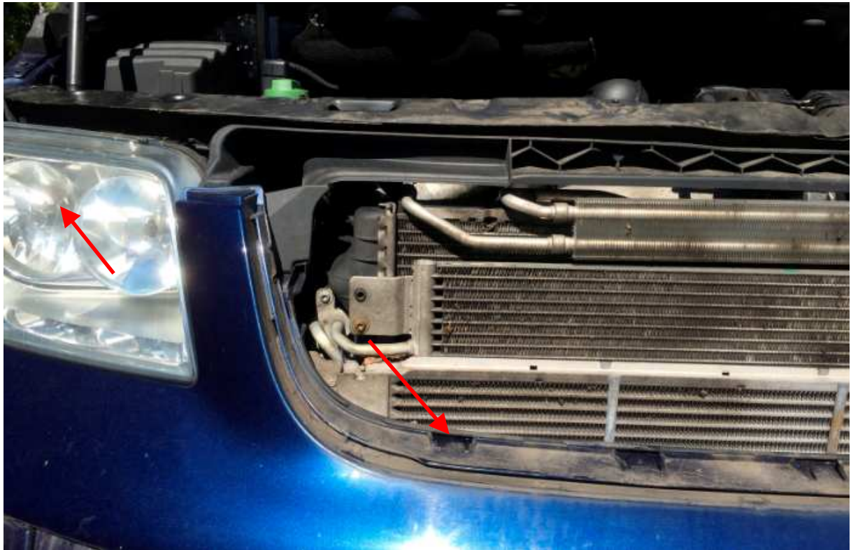
Kühlergrill abbauen, vorsichtig ablösen, Steckverbindungen Hier mit Lampe verschmauckt (roter Pfeil)
